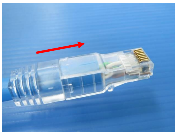
15. プラグ本体を指で固定し、絶縁体と外被がズレない様にケーブル全体をしっかりと固定して押し込む ※ 右上写真のように絶縁体先端がコネクタ先端まで挿入されていることを確認する
