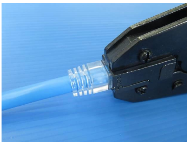
16. カシメ工具にセットし、リリースするまでカシメる ※ カシメ工具:PM-236Q1B-U
